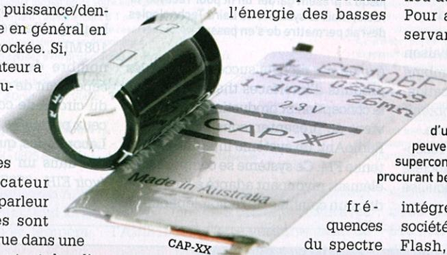
Deux condensateurs aluminium électrolytique de 7 mm de diamètre pour 18 mm de long destinés à l'alimentation d'un flash de téléphone portable peuvent être remplacés par un seul supercondensateur de 17x39x1,1 mm procurant beaucoup plus d'énergie.
